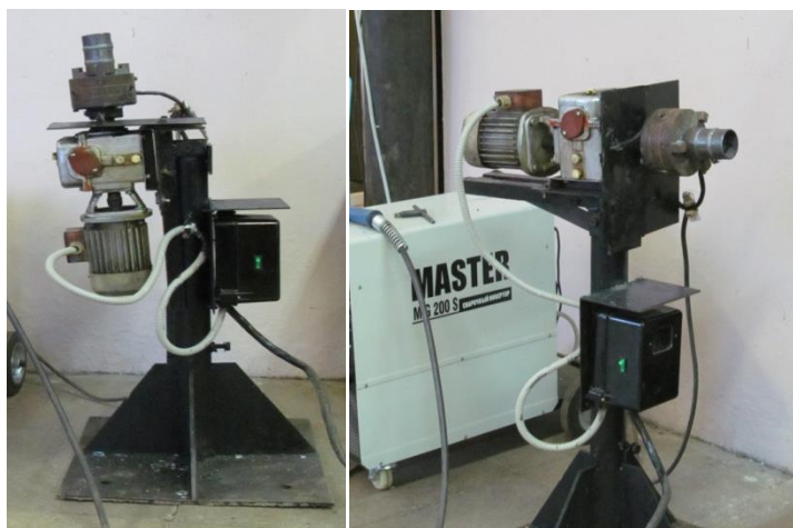
Рис. 1. Манипулятор для полуавтоматической, автоматической сварки кольцевых швов (труб) и наплавки на цилиндрические поверхности (валы, диски)
